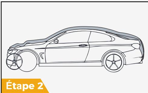
Retirez soigneusement votre housse de l'étui de transport et placez-la sur le toit de votre véhicule en veillant à ce que l'étiquette "front" de la housse soit orientée vers l'avant du véhicule et à ce que la housse ne touche pas le sol. Vous trouverez une étiquette "Front" cousue à l'intérieur de la couture de la housse pour identifier facilement le côté avant de la housse.
