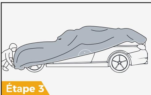
Fixez la partie avant élastique de la housse au pare-chocs avant de votre véhicule. Ensuite, déroulez et tirez la housse par-dessus le toit du véhicule jusqu'à l'arrière et fixez le bord élastiqué au pare-chocs arrière. Attachez les boucles latérales pour fixer la housse en place.
